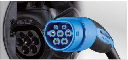
In Europa ist der Elektroanschluss für Fahrzeuge mit dem Stecker "Typ 2" genormt. Somit können Fahrzeuge von verschiedenen Herstellern dort geladen werden. Allerdings variiert die Ladeleistung je nach Hersteller zwischen 3,6 kW und 7,2 kW. Bild: © MENNEKES Elektrotechnik GmbH & Co. KG
